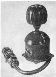
Фиг. 111. Трехжильная рукоятка управления летчика.
