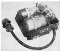
Фиг. 109. Датчик угловых скоростей без кожуха.
