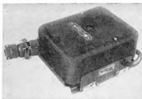
Фиг. 108. Датчик угловых скоростей с закрытым кожухом.
