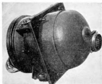
Фиг. 107. Центральная гироскопическая вертикаль ЦГВ-2.
