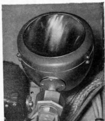
Фиг. 87. Фара ФР-100 для освещения площадки при загрузке через задние загрузочные створки в люке.
